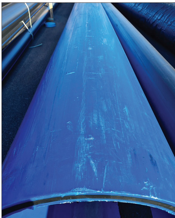
Vidljiva linijska i točkasta oštećenja na površini cijevi
